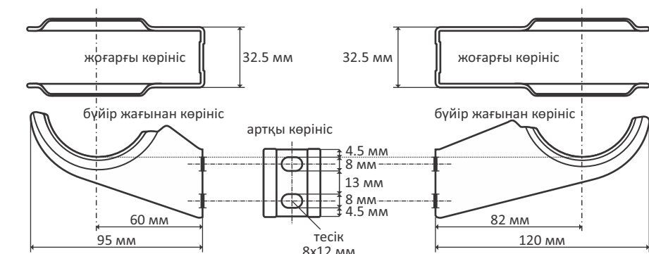
Сурет 5.2 – 120 мм кронштейн (3-құбырлы радиаторлар үшін)
